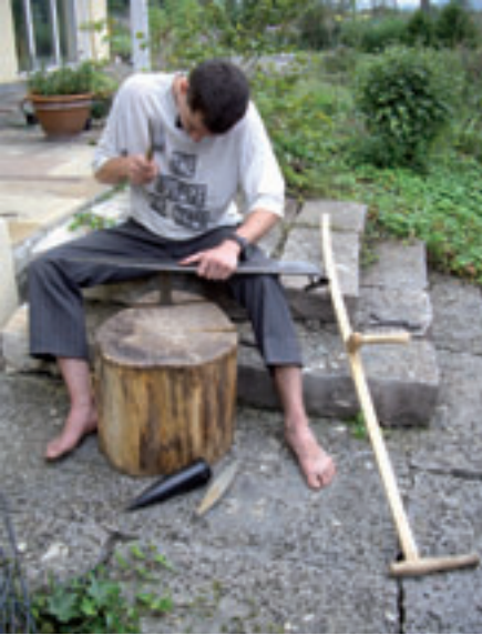
Abb. 2: Zum effizienten Mähen mit einer scharfen Sense sind zwei Arbeitsschritte nötig: Nach längerem Einsatz der Sense wird beim zeitaufwändigen und lauten Dengeln (heute mit Ohrpfropfen) das vom Stiel gelöste Senseblatt an der Schnittkante mit dem Hammer ausgedünnt. Dank der Dünne kann die Schneide beim Mähen effizient mit dem nassen Schleifstein nachgeschärft werden. (Schleifstein und Wassergefäß am Fuss des Holzblocks). Photo M. Fritz, 8. 9. 2010
