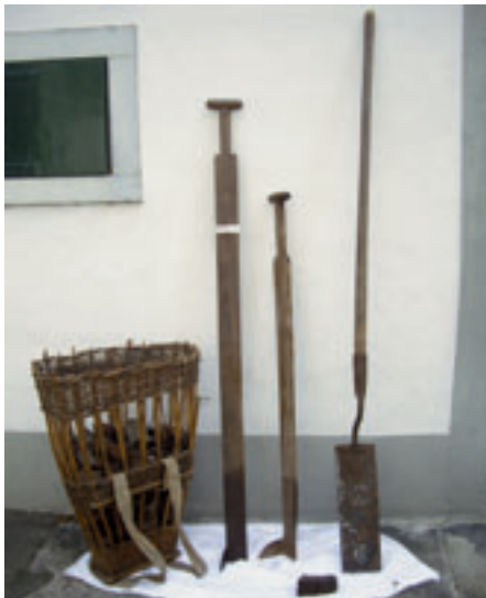
Abb. 5: Ausrüstung für den Torfabbau: Das spatentartig verbreiterte «Turpeschit» zum Abstechen der Torfstücke und der Stiel mit dem Winkelleisen für das genaue Schneiden ihrer Ecken. Der Stiel der Werkzeuge war umso länger, je tiefer unten der Torf gestochen wurde. Der Korb war Transportmittel und ein Mass für den getrockneten Torf. Sammlung Museum am Pfäffikersee, Pfäffikon. Photo M. Fritz, 5. 9. 2010
